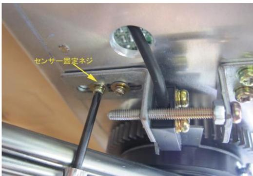
11-3) センサー固定ネジをL型の金具が動けるように少しゆるめます。
